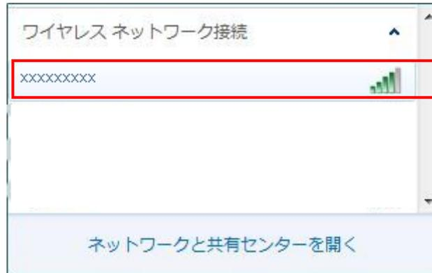
3. 「接続」をクリックします。また、「自動的に接続する」をチェックした場合、無線提供エリア内では、特別な操作なく、自動的に無線 LAN へ接続されます。自動で無線 LAN へ接続したくない場合は、チェックをはずして下さい。
